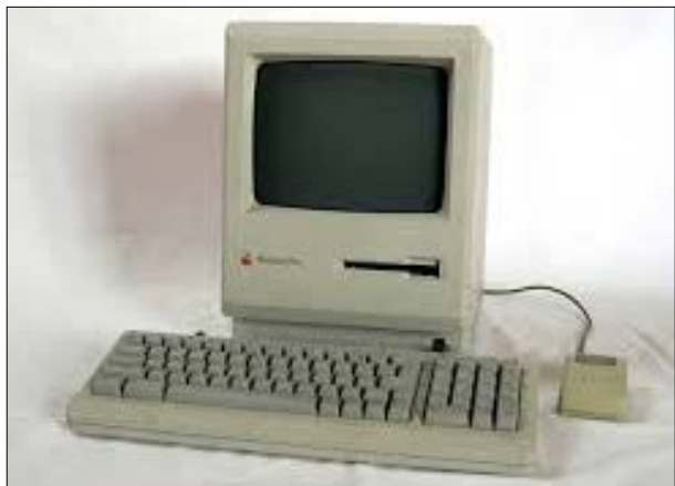
En Macintosh Plus från slutet av 80-talet med ett arbetsminne på fantastiska 128k.
